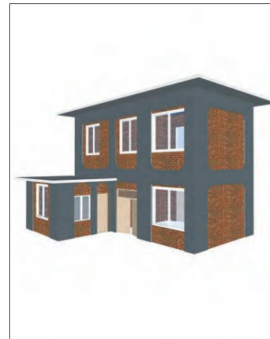
高延性混凝土加固砌体结构示意图(坡屋顶)
