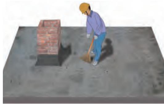
做水泥砂浆找平层前,需将板面上的垃圾、杂物、硬化的砂浆块清除干净,找平层与突起处应抹成光滑一致的圆弧形,圆孤的半径可以为100-150mm左右。
