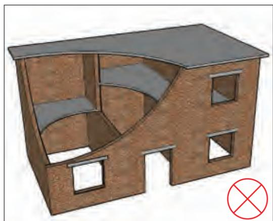
房屋烟道要贴附在墙体外侧或内侧砌筑, 不应削弱墙体。
