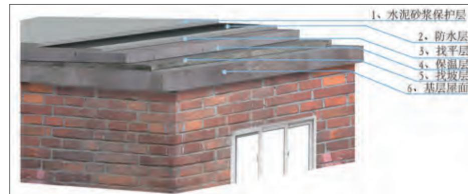
钢筋混凝土平屋顶保温做法
